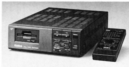
図4 コニカ・スチルビデオレコーダー/ プレーヤーKR-400 Fig.4 Konica still video recorder/player
